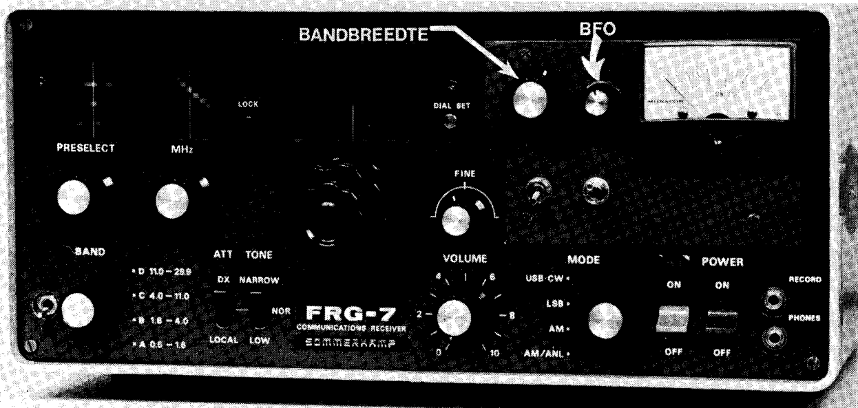
Vooraanzicht van de veranderde FRG-7. Waar vroeger de luidspreker zat is nu een plaatje gemonteerd met daarop onder meer een nieuwe S-meter, de bandbreedteschakelaar, BFO-regeling en een tweetal minischakelaars.
